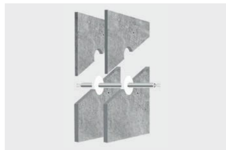
Lietošanas piemērs 2: Vadu blīvēšana ģipškartona, betona sienā un citu masīvo barjeru caurumos.
